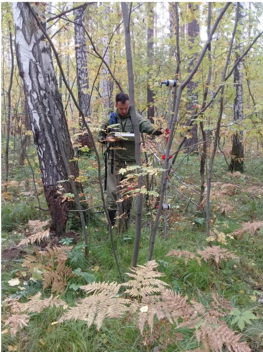
*рис.3. Проведение градиентометрической съемки на участке А1*
